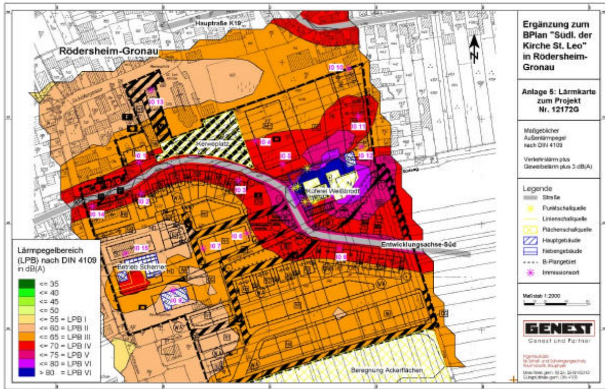
Abbildung 1: Maßgeblicher Außenlärmpegel nach DIN 4109, Verkehrslärm plus Gewerbelärm plus 3 dB(A)
